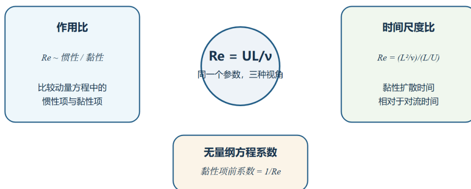
图 3.2: Reynolds 数的三种等价理解：惯性与黏性作用之比、黏性扩散时间与对流时间之比，以及无量纲 Navier–Stokes 方程中黏性项的控制参数。
